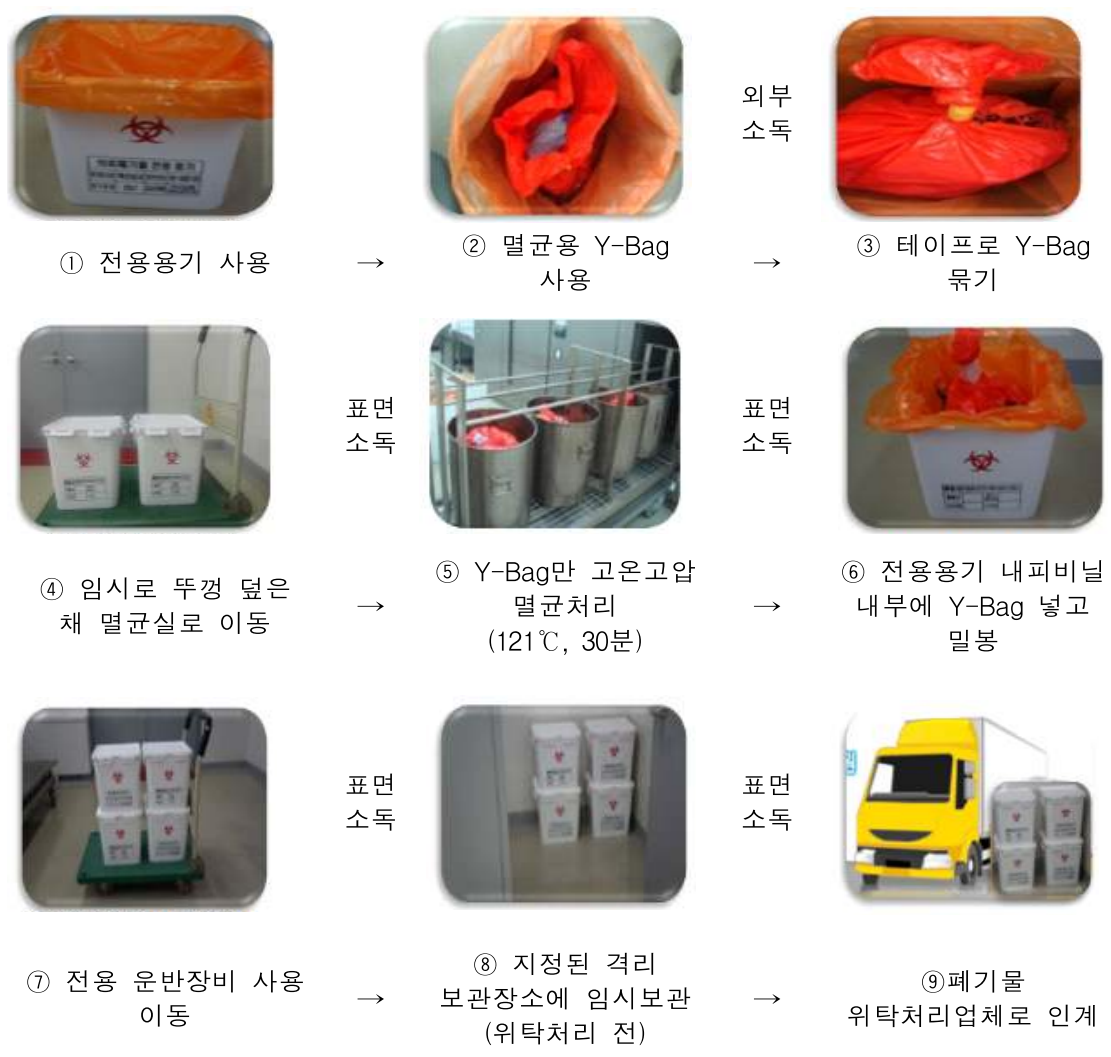
그림. 격리의료폐기물을 고압증기멸균기로 처리 후 배출 할 경우 처리 절차
