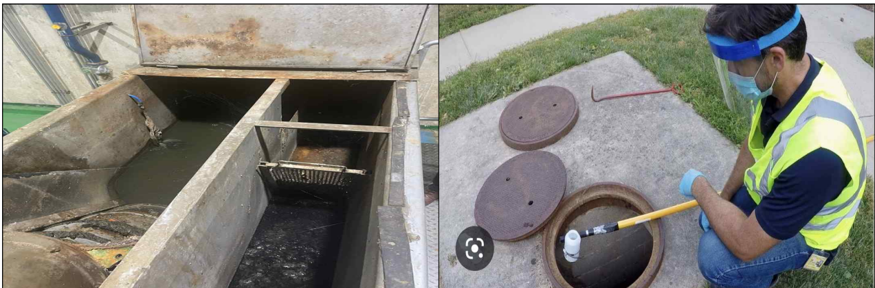
하수 채취 지점 및 채취 방법(예시)
